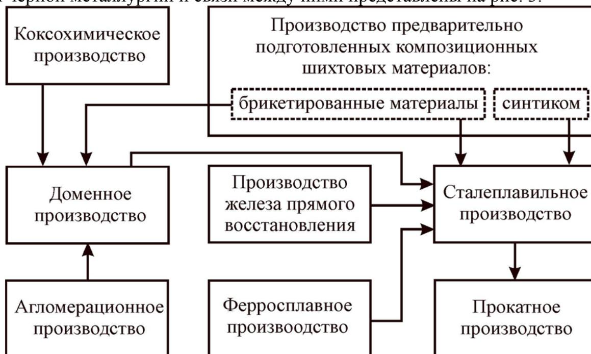
Рис. 3. Основные элементы современной производственно-технологической структуры черной металлургии и связи между ними
